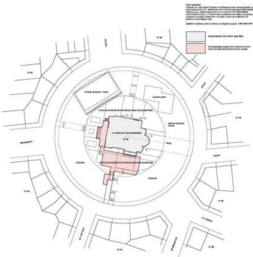
Τοπογραφικό διάγραμμα της πλατείας Βλαχερνών με την πρόταση για διαμόρφωση των υφιστάμενων υπόγειων κατασκευών (κόκκινη διαγράμμιση) σε δημοτικό υπόγειο κτήριο πολιτιστικών δραστηριοτήτων
